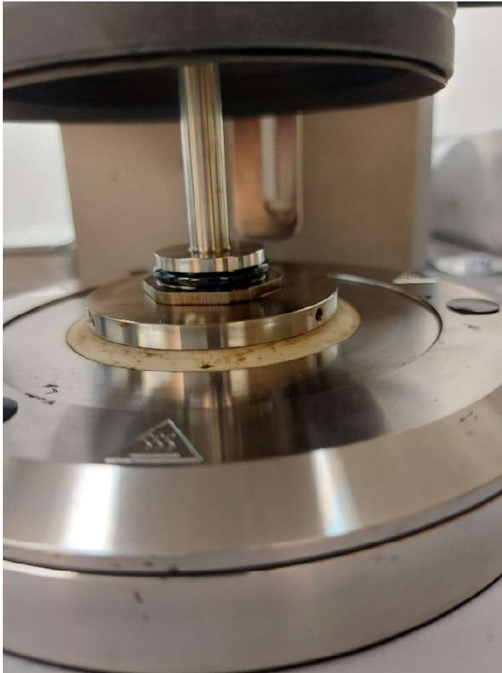
Figur 3 Prov med 0,65g vikt vid 1,05mm gap. Ett tydligt överskott av bitumen syns runt provplattan
