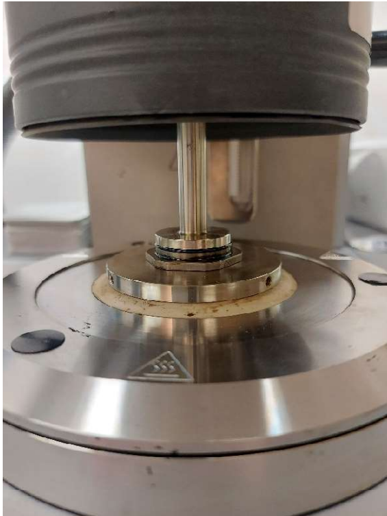
Figur 2 Prov på 0,53g i maskinen med ett gap på exakt 1mm
